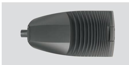
La partie supérieure du luminaire est un élément essentiel au concept de gestion thermique, et contribue grandement à l'esthétique du luminaire. De plus, la surface horizontale de la partie supérieure du luminaire est légèrement arrondie, les dissipateurs verticaux du haut et du bas sont arrondis, et l'écart entre les courbes est calculé en fonction de leur hauteur. Ainsi, le drainage et le nettoyage du luminaire sont optimisés.
