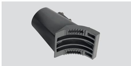
**Luma Mini / Luma 1** : Embout universel pour fixation latérale ou en top de mât Ø 32 à 60 mm (62 mm maxi). Pour les petits diamètres de mât, des vis longues supplémentaires peuvent être commandées, en option, avec le luminaire. La position latérale est facile à obtenir en inversant l'embout à l'aide des 2 vis.
