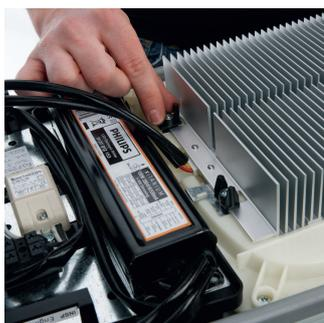
Remplacement du module LED sans outils (Déverrouillage du module LED)
