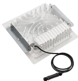
En las luminarias Mini 300 LED gen2, las aletas del disipador térmico radial aumentan la velocidad del aire a través del sistema de refrigeración convectivo, extrayendo calor por radiación de la luminaria de forma efectiva.
