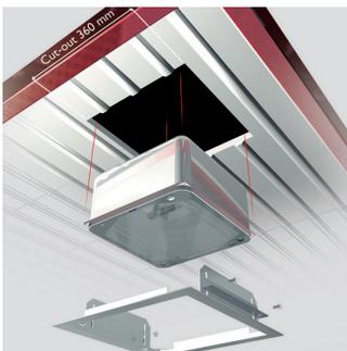
**Rahmen passt in eine quadratische Aussparung mit einer Kantenlänge von 360 mm**
