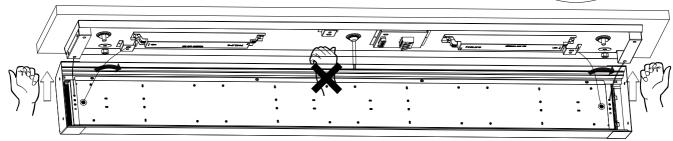
注意事项:安装灯具时,请按图示操作,托举灯具底板两端,不得托举灯具底板中间位置
