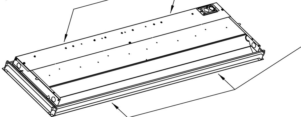
INSTALLER LES AGRAFES ANTISISMQUES TEL QU'ILLUSTRÉ CI-DESSOUS EN POUSSANT L'AGRAFE SUR LA BORDURE DU LUMINAIRE ET LORS DE L'INSTALLATION DU LUMINAIRE DANS LE PLAFOND DE TUILES, ENCLENCHER LES AGRAFES SUR LE PROFILÉ EN T
