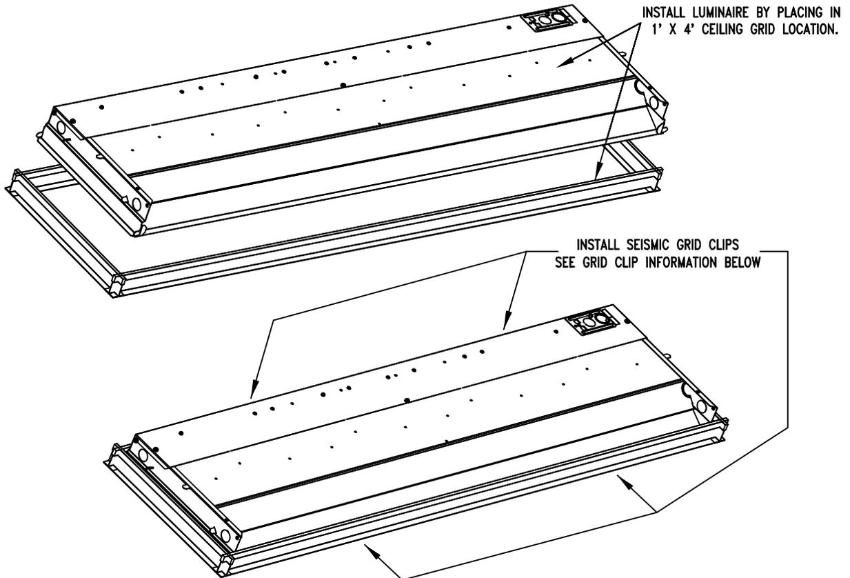
INSTALL SEISMIC GRID CLIPS AS SHOWN BELOW BY PUSHING CLIP ONTO LUMINAIRE FLANGE AND SNAP OVER T-BAR AS LUMINAIRE IS INSTALLED IN CEILING GRID.
