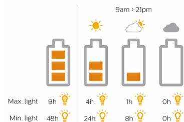
Das Gerät benötigt Sonne zum Aufladen, und die Länge der Beleuchtungsdauer hängt von der Menge des Sonnenlichts ab, welche das Solar-Panel aufnimmt. Mit voll aufgeladenem Akku kann das Produkt bis zu 9 Stunden Licht mit der höchsten Lichtintensität abgeben. Zur Verlängerung der Dauer können Sie das Licht dimmen. Je mehr Sie es dimmen, desto länger reicht die Lichtleistung aus. Mit voll geladenem Akku haben Sie bis zu 22 Stunden Licht auf der niedrigsten Stufe.
