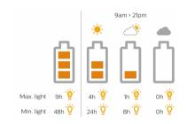
Le produit a besoin de la lumière du soleil pour se recharger, et son autonomie dépend de la quantité de lumière du soleil que le panneau solaire aura reçu. Une charge complète permet d'obtenir jusqu'à 9 heures d'éclairage à intensité de lumière maximale. Pour prolonger la durée d'autonomie, vous pouvez réduire le flux lumineux. Plus elle est basse, plus l'éclairage durera longtemps. Une charge complète permet d'obtenir jusqu'à 22 heures d'éclairage à intensité de lumière minimale.
