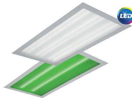
Le luminaire DEL **SurgiCare** de Day-Brite / CFI est entièrement scellé pour une protection maximale dans les salles d'opération. Le boîtier ne présente aucune ouverture au-dessus du plafond et le luminaire est scellé à la structure à l'aide d'un joint d'étanchéité. La porte est également scellée et maintenue en place à l'aide de vis imperdables. Les câbles de sécurité retiennent la porte de façon sécuritaire sur le boîtier pour faciliter l'entretien.
