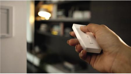
Mit dem batteriebetriebenen Dimmschalter kannst Du bis zu 10 intelligente Leuchten gleichzeitig steuern. Der Schalter – der von seiner Wandbefestigung abgenommen und als Fernbedienung verwendet werden kann – ermöglicht das Dimmen und Aufhellen der Leuchten sowie das
