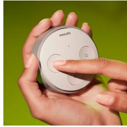
El interruptor Tap funciona con energía cinética, lo que significa que cuando pulsas el interruptor de la luz generas energía suficiente para controlar las luces inteligentes. Una perfecta solución inalámbrica y sin pilas.
