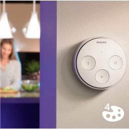
Con el interruptor Tap puedes recuperar cuatro escenas de iluminación predefinidas o encender y apagar las luces pulsando un botón. Utiliza la aplicación para configurar tus escenas personales o escenas creadas por diseñadores de iluminación. Puedes utilizar el interruptor Tap sin abrir Philips Hue app e incluso con la wifi desconectada.
