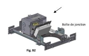
Acheminez le **circuit d'attaque** du **générateur** de **lumière** en passant par le trou d'ouverture dans le plafond et enclenchez-le dans la boîte de jonction. Comprimez les deux ressorts de garniture vers le haut tout en enfonçant le réflecteur de garniture dans la découpe du plafond. Voir les Figs. B1 et B2. Remarque : La garniture peut être retirée en saisissant la bride du réflecteur et en la tirant directement vers le bas.
