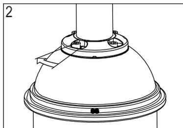
2. Turn the luminaire clockwise to engage the head of the screws in the keyhole slots. Tournez le luminaire dans le sens horaire pour engager la tête des boulons dans le chemin de clés.
